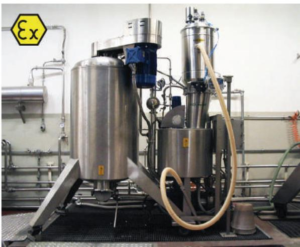
Système de transport de perlite, à air comprimé pour zone **ATEX 1-2** sur une unité filtrante dans une distillerie.
