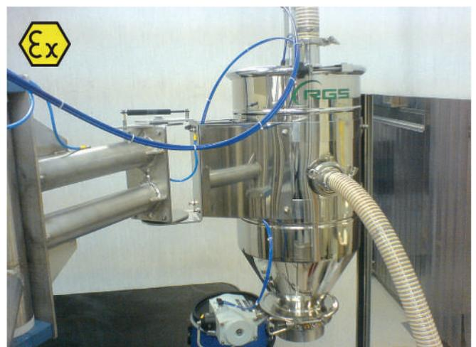
Système de transport pour poudres pharmaceutiques mélangées en acier inox AISI 316L avec finitions polies dans une industrie pharmaceutique. Système réalisé en version **ATEX** pour zone 21-22.
