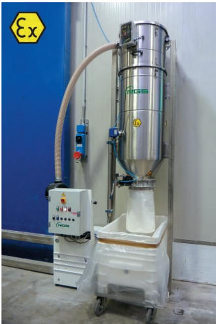
Convoyeur pneumatique pour farines et résidus de traitement dans une pizzeria industrielle. Système réalisé en version **ATEX** pour zone 22 poudres.
