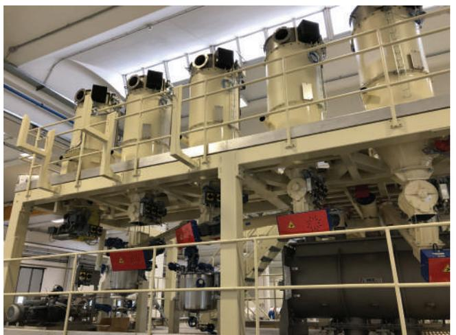
*Convoyeur pneumatique pour poudres de tabac, stockage en silos et dosage sur mélangeur.*
