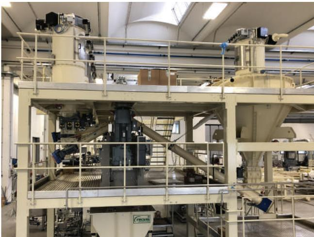
*Convoyeur pneumatique pour poudres de tabac, stockage en silo et dosage sur mélangeur.*
