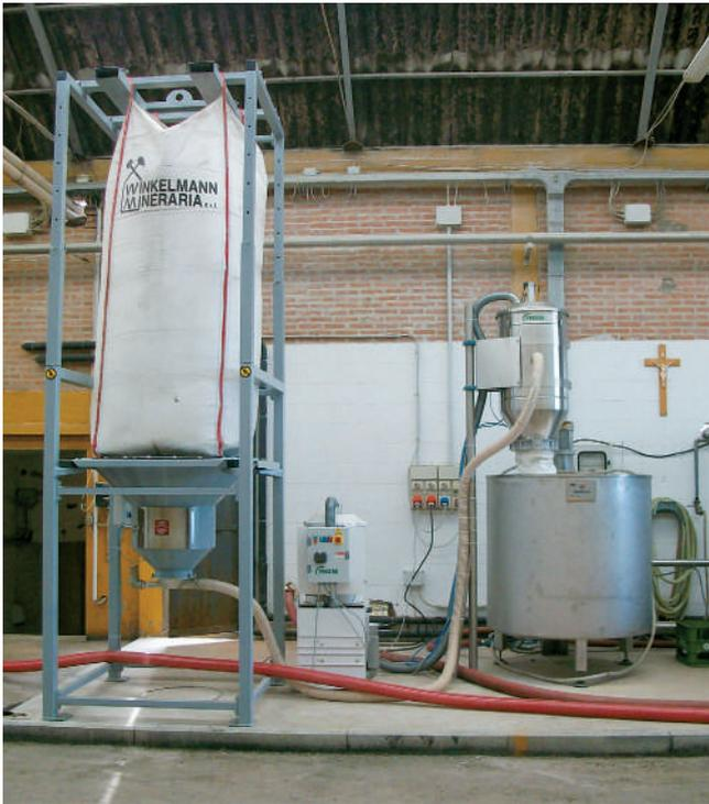
Système de transport des farines fossiles avec prélèvement du système vide les big-bags et transfert sur le filtre dans une cave.
