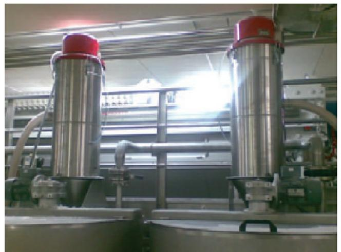
Système composé de deux convoyeurs monophasés qui chargent deux réservoirs pour la préparation du composé filtrant à farine fossile.
