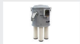
Possibilité de monter des **systèmes de secouage automatique des filtres** via un piston pneumatique ou un moteur électrique
