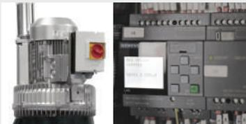
**Moteurs asynchrones triphasés** puissants convenant à une utilisation intensive et continue. Déjà préparés, via PLC dans le tableau de distribution, pour les systèmes centralisés avec démarrage à distance au moyen d'une buse spéciale ou de configurations sur
