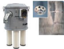
Disponible avec un système de filtre à cartouche avec nettoyage automatique continu pour garantir le maintien de l'efficacité de l'aspiration au fil du temps
